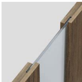
spojení se sklem „na hranu“ křídlo polodrážkové
