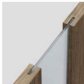
spojení se sklem „na hranu“ křídlo bezpolodrážkové
